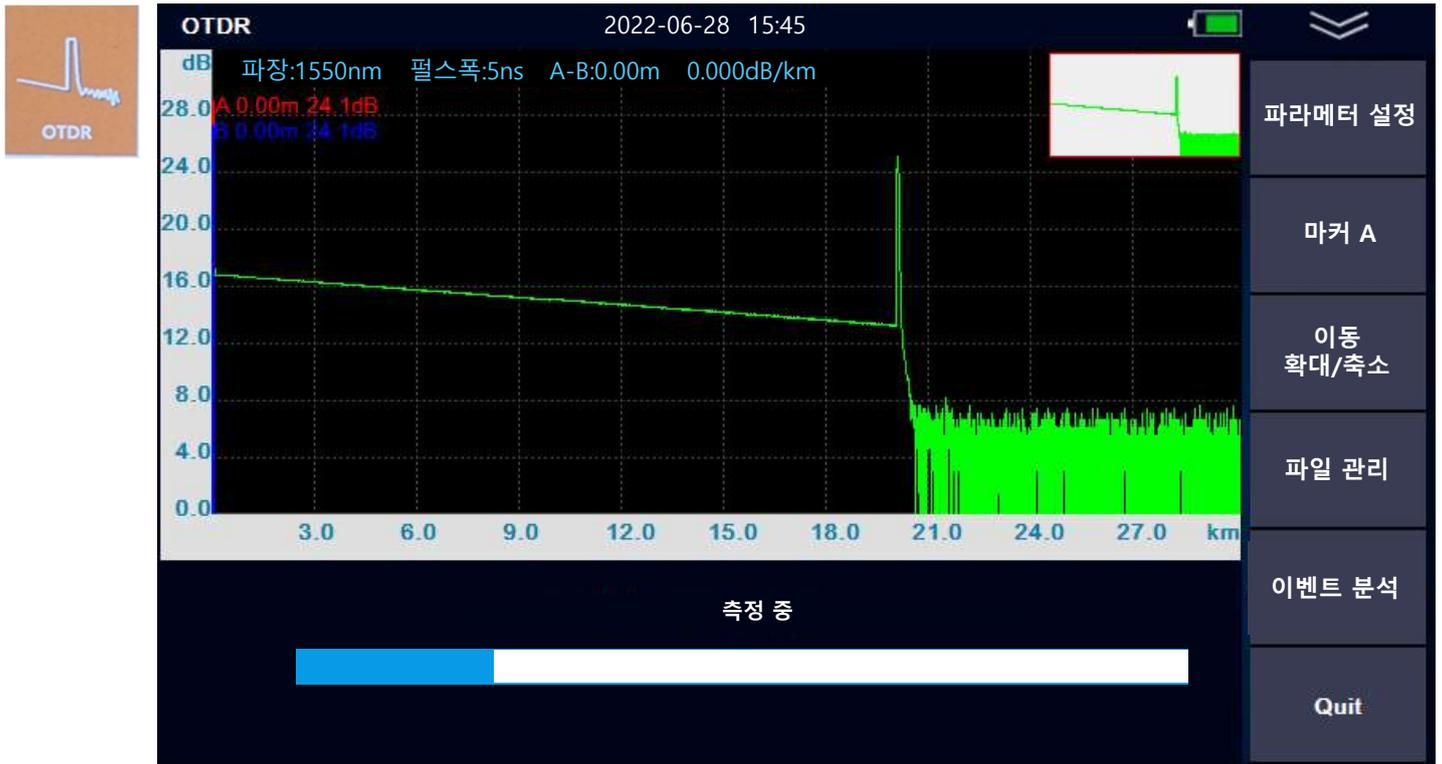
홈화면의 [OTDR] 아이콘을 누르면 위와 같이 OTDR 측정 화면으로 들어갑니다.
