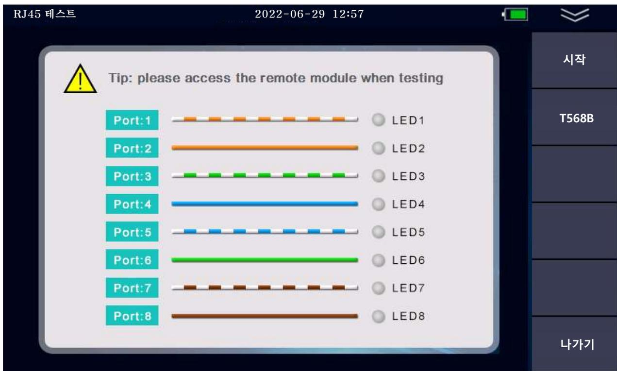
홈화면의 [네트워크 케이블 테스트] 아이콘을 누르면 위와 같이 RJ45테스트 화면으로 들어갑니다. 메뉴는 아래와 같습니다.
