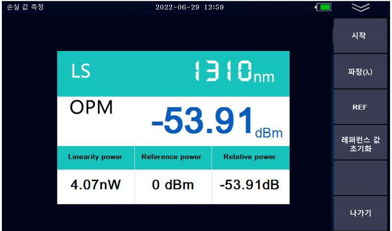
홈화면의 [광손실 테스트] 아이콘을 누르면 위와 같이 손실 값 측정 화면으로 들어갑니다. 측정기의 광원과 광파워미터를 동시에 이용하여 측정하는 메뉴입니다. 메뉴는 아래와 같습니다.
